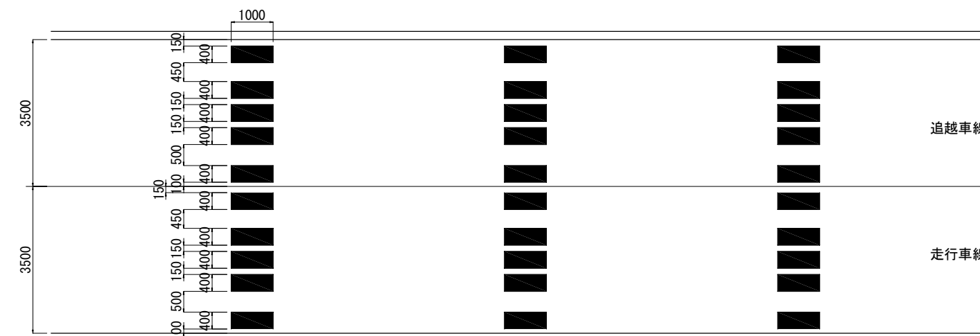
路面標示JIS規格型C1詳細図 縮尺 1 : 12.5
